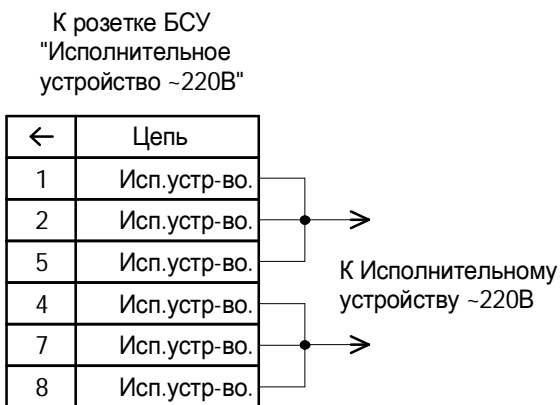
Рисунок Б.5 - Схема распайки вилки подключаемой к разъёму "Исполнительное устройство" БСУ
