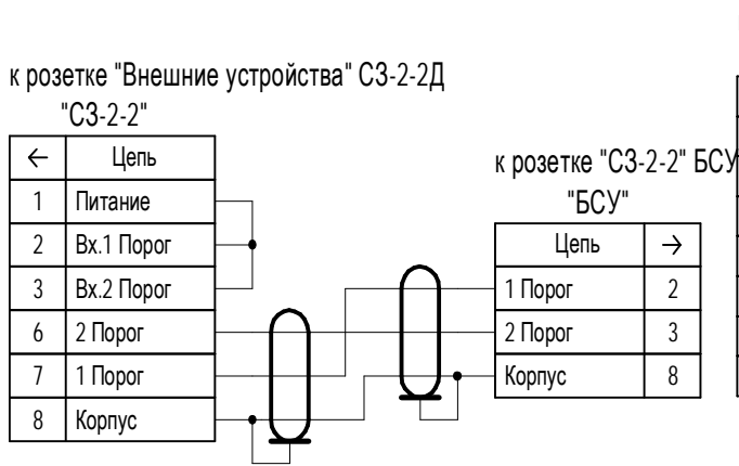
Рисунок Б.1 - Схема кабеля для подключения СЗ-2-2 к БСУ
