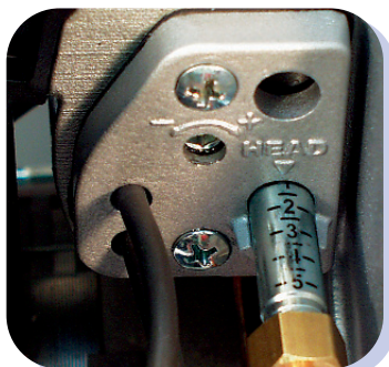
Setting combustion head Регулировка огневой головки
